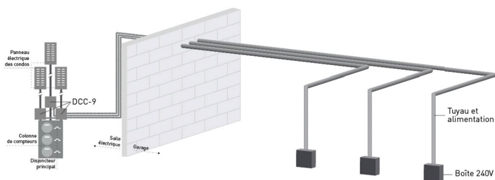
Figure B-7 : Exemple de plusieurs dispositifs de surveillance des lignes d'alimentation installés sur une pile de compteurs desservant un garage de stationnement. Source : MURBLY/RVE.
